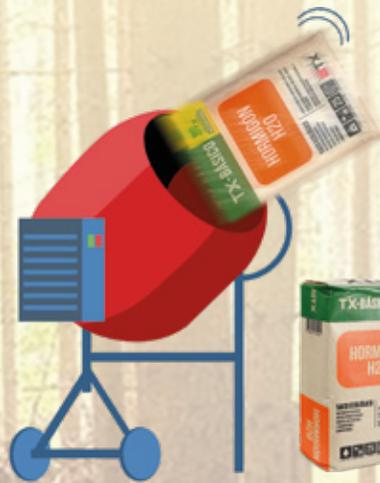
INTRODUCE EL SACO SIN ABRIRLO EN LA BETONERA Y AGREGA 3 LITROS DE AGUA APROXIMADAMENTE
